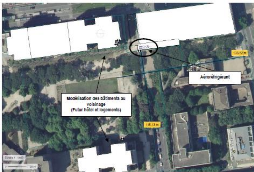
Distance de l'aéroréfrigérant aux bâtiments voisins
